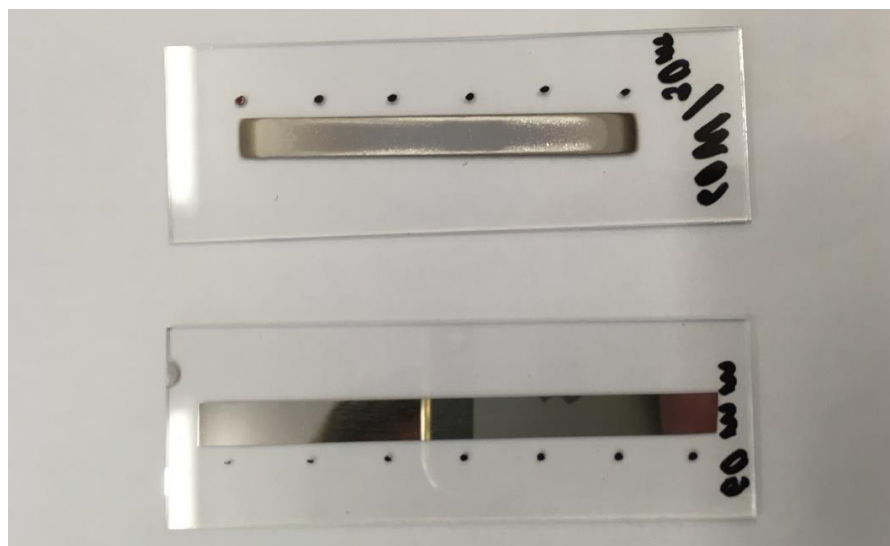
Obr. 22: Tenké vrstvy nanášené technologií napařování (nahore) a napařování (dole)
